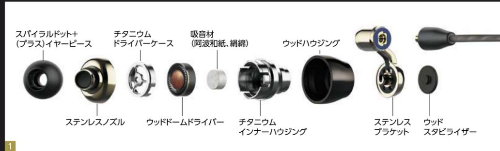
1 「HA-FW10000」の構造図。チタン、ステンレス、ウッドといった異素材を掛け合わせて不要振動を抑え込む構成となっている。
