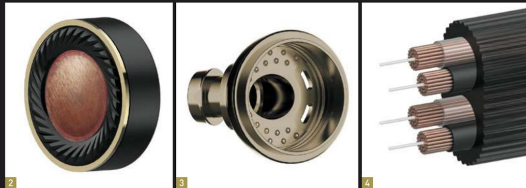
2 ウッドドームドライバーの振動板は、カーボンコーティングPETの中央に50μmの薄さに加工した樺材を貼り付けている。音の雑味を抑えるために、前面にチタニウムドライバーケースを設けている。
