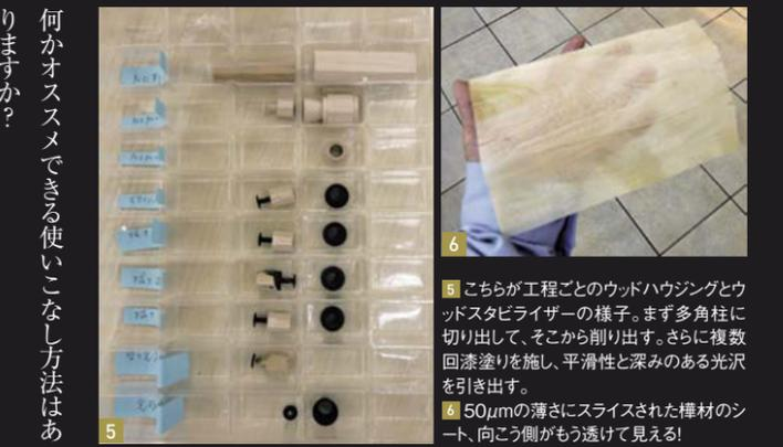
5 こちらが工程ごとのウッドハウジングとウッドスタビライザーの様子。まず多角柱に切り出して、そこから削り出す。さらに複数回漆塗りを施し、平滑性と深みのある光沢を引き出す。
